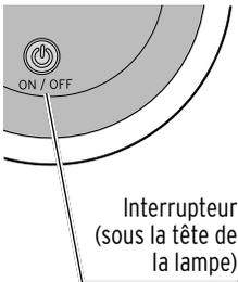
▷ Pour **allumer les LED**, appuyez **brèvement** sur l'interrupteur. L'intensité lumineuse des LED est celle qui était réglée avant l'extinction de la lampe.
