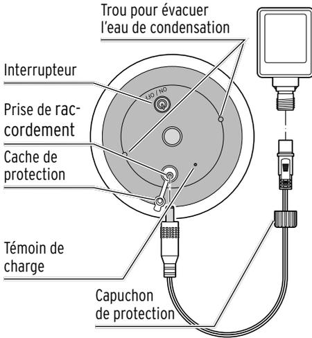
2. Branchez une extrémité du câble d'alimentation dans la prise de raccordement située sous l'abat-jour et l'autre extrémité dans la prise de raccordement du bloc-secteur. Vissez le capuchon de protection.
