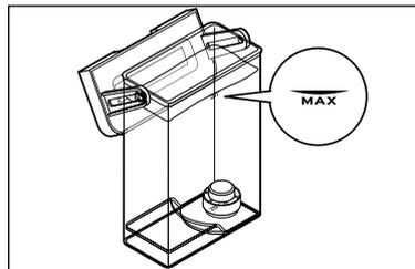
2. Remplissez le réservoir d'eau vide avec un détartrant liquide standard pour machines à café et expresso. Ajoutez de l'eau jusqu'au repère MAX. Respectez les consignes du fabricant.
