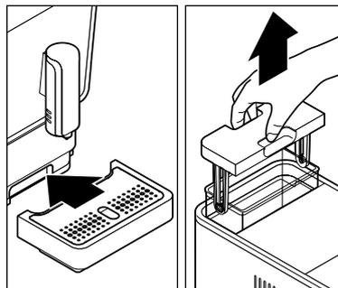
2. Poussez le ramasse-gouttes muni du repose-tasse contre la machine, comme sur l'illustration.
