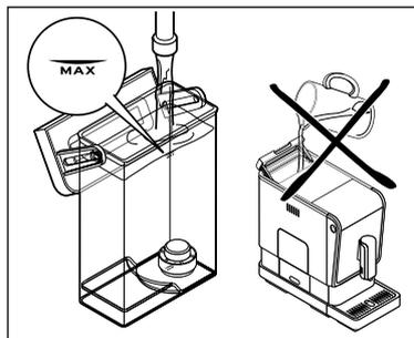
4. Remplissez le réservoir d'eau jusqu'au repère MAX avec de l'eau fraîche et froide du robinet ou une autre eau potable. Ne remplissez jamais le réservoir d'eau quand celui-ci est encore dans la machine!
