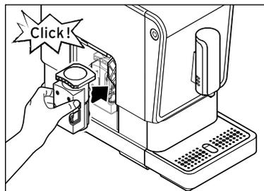
7. Renforcez l'unité de percolation dans la machine en la tenant droite et en forçant légèrement, sans appuyer sur les boutons orange. L'unité de percolation doit s'enclencher de manière audible et perceptible.
