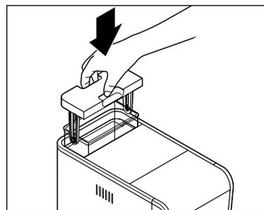
6. Remettez le réservoir d'eau dans la machine et enfoncez-le à fond vers le bas.
