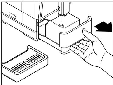
1. Videz régulièrement le bac d'égouttage, le récipient à marc de café et le ramasse-gouttes. Retirez le ramasse-gouttes. Sortez le bac d'égouttage avec le récipient à marc de café de la machine.
