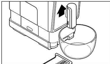
11. Placez un récipient vide (d'une capacité d'au moins 500 ml) sous la sortie du café. Vous devrez peut-être vider plusieurs fois le récipient placé en dessous pendant la phase de rinçage.
