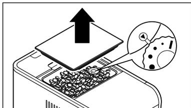
3. Retirez le couvercle du réservoir à grains.
