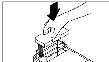
3. Remplacez le réservoir d'eau dans la machine. Enfoncez-le à fond vers le bas.
