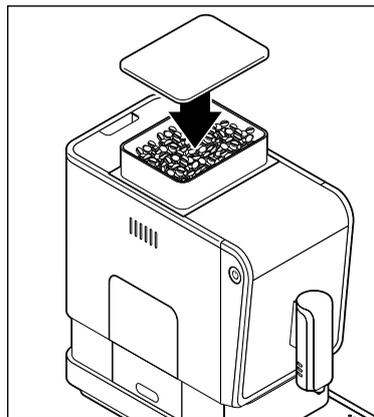
5. Remplacez le couvercle sur la rehausse. Poussez le couvercle à fond pour que le joint de protection de l'arôme préserve l'arôme du café de manière optimale.
