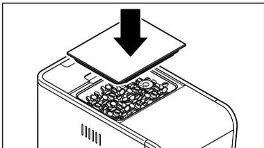
8. Remplacez le couvercle sur le réservoir à grains. Poussez le couvercle à fond pour que le joint de protection de l'arôme préserve l'arôme du café de manière optimale.
