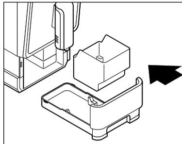
3. Remettez le récipient à marc de café dans le bac d'égouttage et remplacez les deux pièces dans la machine.
