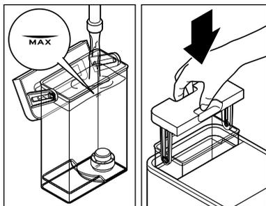
12. Remplissez le réservoir d'eau du robinet froide jusqu'au repère MAX.
