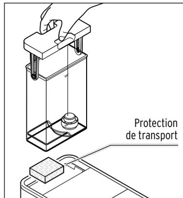
4. Retirez la protection de transport située sous le réservoir d'eau.
