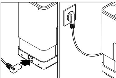
9. Insérez la fiche de connexion dans la prise située à l'arrière de la machine.
