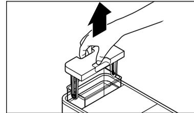
9. Retirez le réservoir d'eau de la machine.
