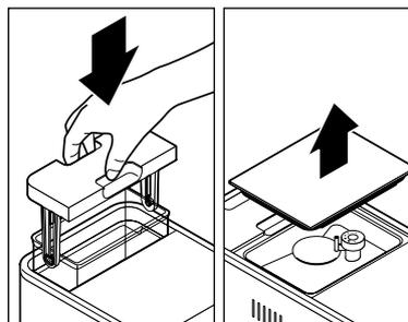
5. Remplacez le réservoir d'eau dans la machine. Enfoncez-le à fond vers le bas.
