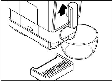
4. Placez un récipient vide (d'une capacité d'au moins 500 ml) sous la sortie du café. Retirez le ramasse-gouttes si besoin est. **Ce récipient devra être vidé plusieurs fois pendant le détartrage.**
