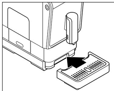
4. Mettez le repose-tasse dans le ramasse-gouttes et repoussez le ramasse-gouttes à fond contre la machine.
