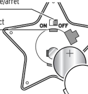
2. Poussez la languette sur le couvercle du compartiment à pile vers le côté et retirez le couvercle vers le haut.
