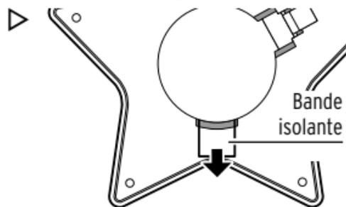
Retirez prudemment la bande isolante du compartiment à pile. Le cas échéant, ouvrez le compartiment à pile comme décrit ci-dessous.
