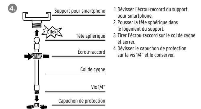
1. Dévisser l'écrou-raccord du support pour smartphone.
