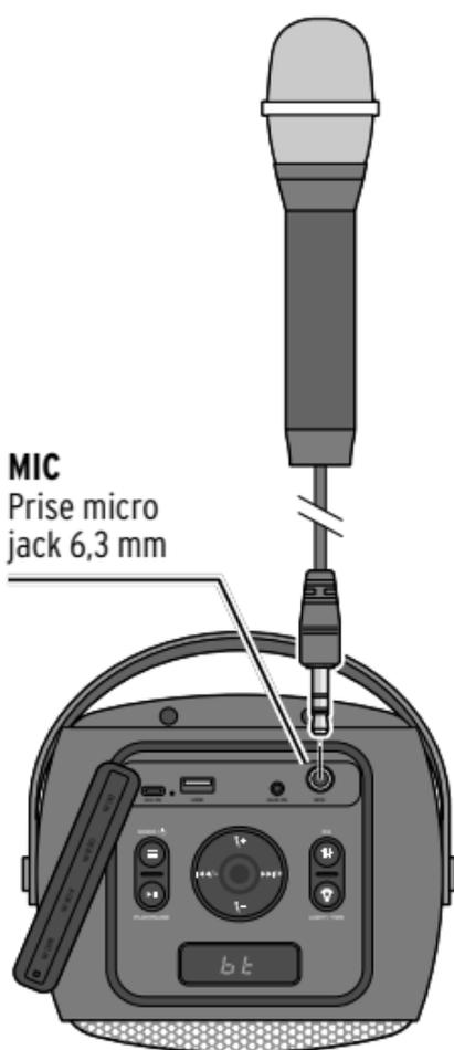
1. Avant de brancher le micro, baissez le volume du micro sur l'enceinte de fête. Pour cela, appuyez sur **MIC-** sur l'appareil ou sur **MIC-** sur la télécommande.
