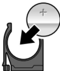
3. Insérez le compartiment à pile jusqu'à la butée dans la télécommande.
