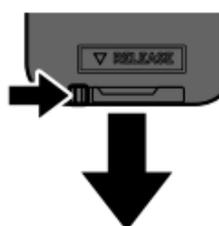
2. Remplacez la pile usée par une neuve. Insérez la pile en respectant la bonne polarité (+ vers le haut).
