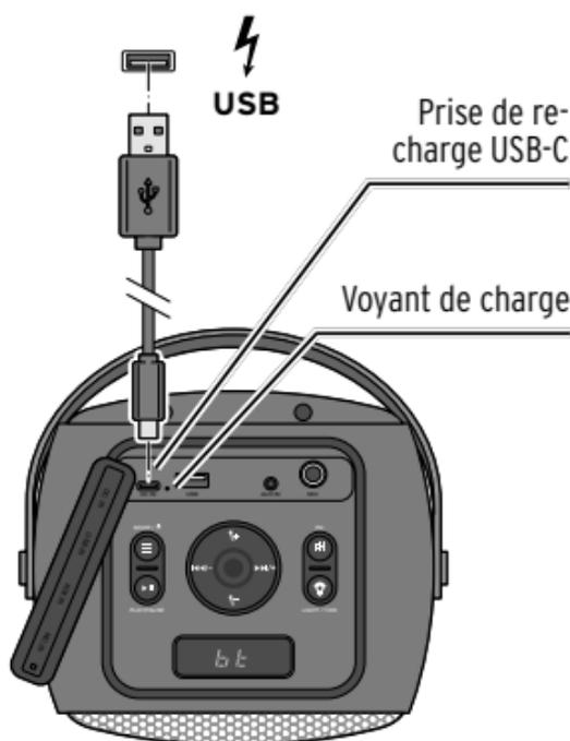
2. Raccordez le câble de charge USB fourni à la prise d'alimentation **DC IN** de l'appareil et à un adaptateur secteur USB approprié (voir «Caractéristiques techniques»). Branchez l'adaptateur secteur dans une prise de courant.
