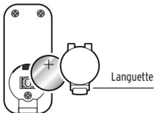
1. Poussez la petite languette du couvercle du compartiment à pile vers le haut et retirez le couvercle vers le haut.
