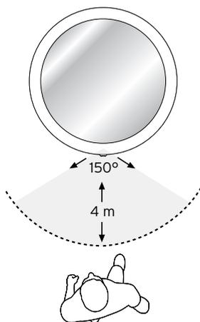
Dès que le capteur radar détecte un mouvement dans son angle de détection (voir l'illustration), l'éclairage à LED s'allume automatiquement pendant 50 secondes environ.
