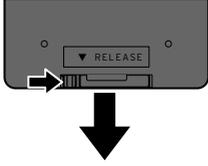
1. Appuyez sur le dispositif de blocage dans le sens de la flèche et retirez le support de la pile.
