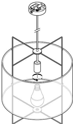
**i** Utilisez uniquement le type d'ampoule indiqué dans les «Caractéristiques techniques».
