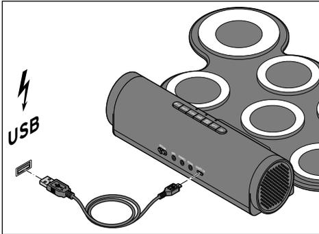
1. Connectez la fiche Micro-USB du câble USB à la prise **USB/DC5V** de l'appareil et la fiche USB-A à l'adaptateur secteur USB.
