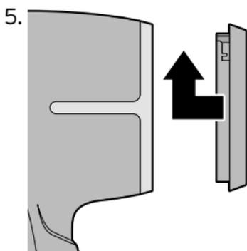
Remettez la grille en place et tournez-la dans le sens des aiguilles d'une montre jusqu'à ce que vous la sentiez s'encliqueter.
