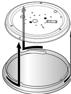
Dévissez le support du plafonnier dans le sens inverse des aiguilles d'une montre jusqu'à la butée et retirez-le du cache du plafonnier.
