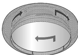
Enfoncez le cache du plafonnier sur le support du plafonnier en veillant à ce que les butées de fixation et les guidages coïncident exactement.
