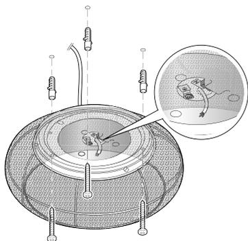
Passez les fils électriques (câble de plafond) dans le passage de câble du support du plafonnier. Fixez le support avec l'abat-jour au plafond à l'aide des vis et des chevilles.
