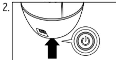
**Pour allumer l'appareil**, appuyez sur l'interrupteur marche/arrêt et maintenez-le enfoncé pendant 3 secondes environ.
