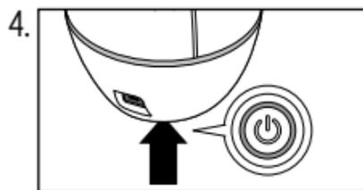
**Pour éteindre l'appareil,** appuyez sur l'interrupteur marche/arrêt et maintenez-le enfoncé pendant 3 secondes environ. Le voyant lumineux situé sur la face inférieure s'éteint.
