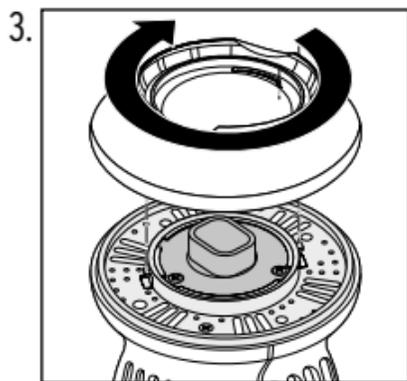
Remplacez le cache et vissez-le en tournant dans le sens des aiguilles d'une montre jusqu'à la butée.
