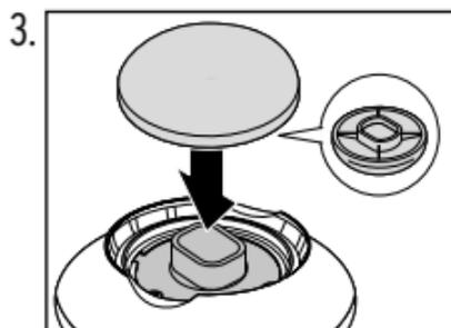
**Pour mettre l'embout en place,** enfoncez l'embout sur l'appareil, comme indiqué sur l'illustration, et appuyez dessus jusqu'à la butée.
