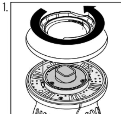
Dévissez le cache en tournant dans le sens inverse des aiguilles d'une montre jusqu'à la butée et relevez-le.
