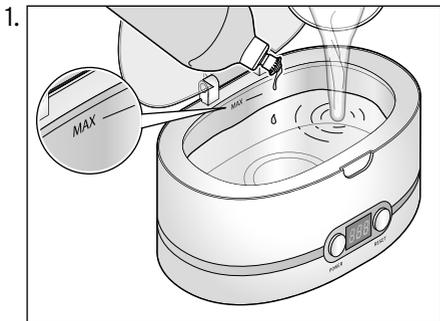
Remplissez l'appareil d'eau et ajoutez-y deux ou trois gouttes de produit à vaisselle doux ou de solution spéciale pour nettoyage aux ultrasons.
