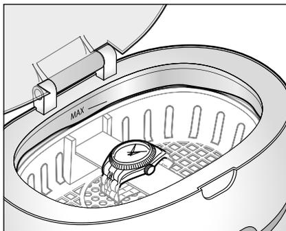
Placez la montre sur le support comme indiqué sur l'illustration. Le boîtier de la montre ne doit pas être immergé dans l'eau.
