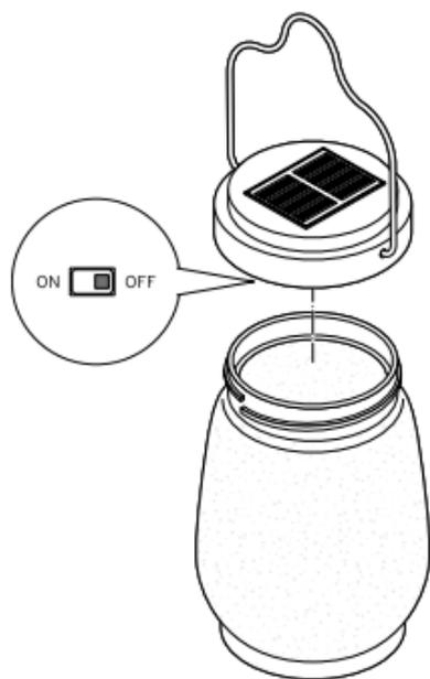
1. Dévissez la tête de lampe (couvercle) du verre en la tournant dans le sens inverse des aiguilles d'une montre.
