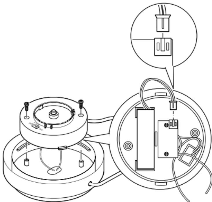
3. Le boîtier électronique est relié au module solaire sur le haut du couvercle par des câbles. **Séparez donc les deux parties du couvercle avec précaution pour ne pas arracher les câbles.**
