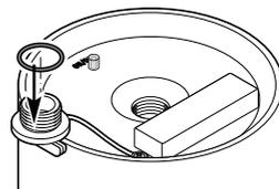
Repoussez le joint d'étanchéité complètement sur le filetage du capuchon vissé pour assurer l'étanchéité, et revissez le capuchon vissé dans le sens des aiguilles d'une montre.
