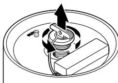
Dévissez le capuchon vissé dans le sens inverse des aiguilles d'une montre et retirez-le.
