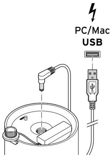
Branchez la fiche de raccordement du câble USB dans la prise de raccordement, et la fiche USB dans le port USB de votre ordinateur ou sur un adaptateur USB approprié.
