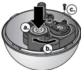
3. Enfoncez complètement la pile dans le compartiment (**a.**) et remettez le couvercle en position fermée (**b.**). Vous devez l'entendre et le sentir s'enclencher. Revissez la vis du couvercle du compartiment à pile jusqu'à la butée (**c.**).
