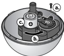
2. Dévissez la vis du couvercle du compartiment à pile (**a.**). Poussez le couvercle du compartiment à pile sur le côté (**b.**) et mettez la pile fournie dans le compartiment comme indiqué sur l'illustration (**c.**) en respectant la bonne polarité (+/-).
