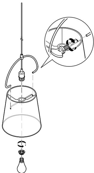
1. Fixez l'abat-jour à la douille avec la bague fileté et avec les deux vis à ailettes à l'étrier de suspension.
