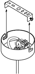
2. Dévissez les deux vis latérales fixant l'étrier de fixation au cache-fils jusqu'à ce que vous puissiez retirer l'étrier.
