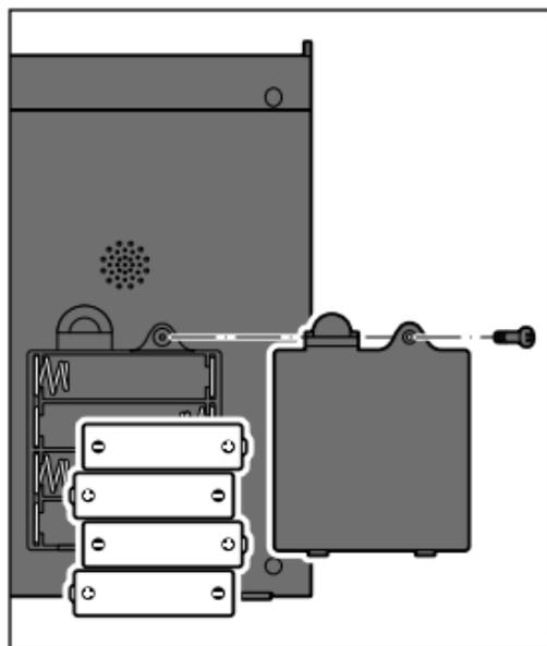
1. Dévissez la vis du compartiment à piles et retirez le couvercle.
