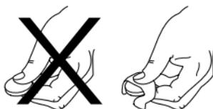
Si vous touchez la pile avec les mains nues, les dépôts laissés par vos doigts pourraient causer des faux contacts. Aussi, lorsque vous mettez la pile en place, manipulez-la toujours avec un chiffon doux et sec.
