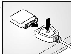
Débranchez la fiche de raccordement de l'unité de commande de la prise de raccordement de la couverture chauffante. Pour ce faire, appuyez sur le bouton situé au-dessus de la fiche de raccordement pour la libérer du verrouillage.
