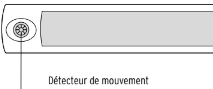
Le détecteur de mouvement peut détecter les mouvements jusqu'à 3 m de distance avec un angle de 110° et allumer ensuite le luminaire à LED.
