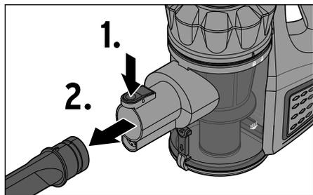
1. Appuyez sur le bouton de déverrouillage du tube ou du suceur (1.) et tirez sur le tube ou le suceur pour l'enlever du bloc-moteur (2.).
