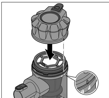
8. Placez le cache du bac à poussière sur le bac à poussière. Le marquage sur le cache doit être aligné avec le symbole
