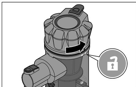
2. Tournez le cache du bac à poussière dans le sens inverse des aiguilles d'une montre en direction de
