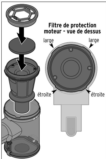
5. Remplacez le filtre de protection moteur en premier. Le filtre de protection moteur ne se remet correctement en place que dans une position: les encoches étroites doivent être orientées vers l'avant en direction du tube et les encoches larges vers l'arrière (voir l'illustration).
