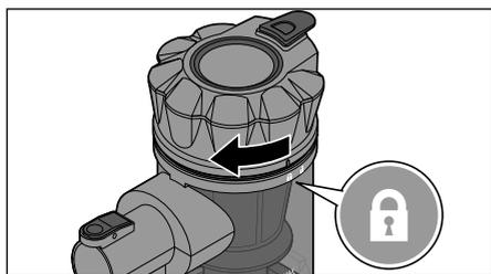
9. Tournez le cache du bac à poussière dans le sens des aiguilles d'une montre en direction de
