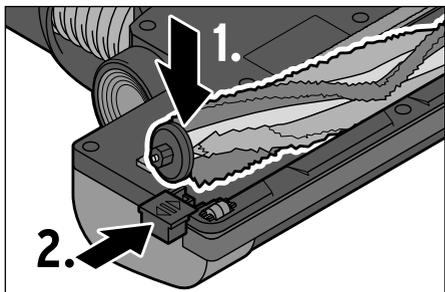
6. Remettez la brosse rotative en place dans son logement (1.) et repoussez le bouton de déverrouillage vers l'intérieur jusqu'à la butée (2.).
