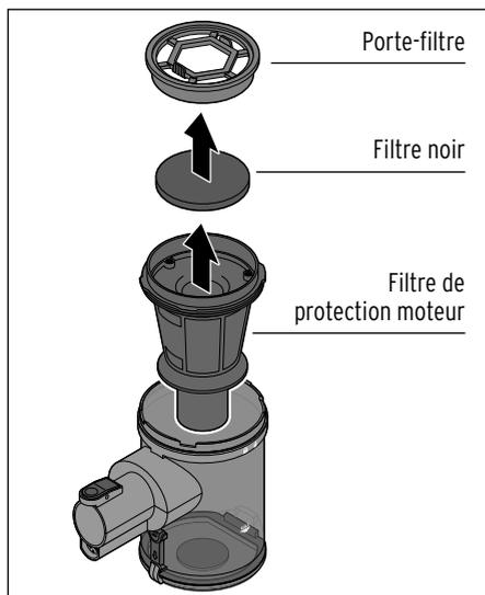
3. Retirez le porte-filtre, le filtre noir et le filtre de protection moteur.
