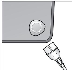
Débranchez la fiche de raccordement de la prise de l'appareil.
