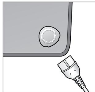
Connectez la fiche de raccordement de l'unité de commande dans la prise de raccordement du coussin chauffant, comme sur l'illustration. La fiche ne peut s'insérer dans la prise que dans la position représentée sur l'illustration.
