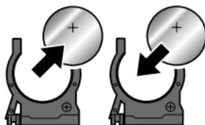
2. Remplacez la pile usée par une neuve en respectant la bonne polarité (le symbole + doit être en haut).
