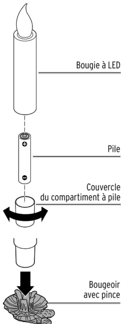
1. Retirez le couvercle du compartiment à pile de la bougie en le tournant dans le sens inverse des aiguilles d'une montre.
