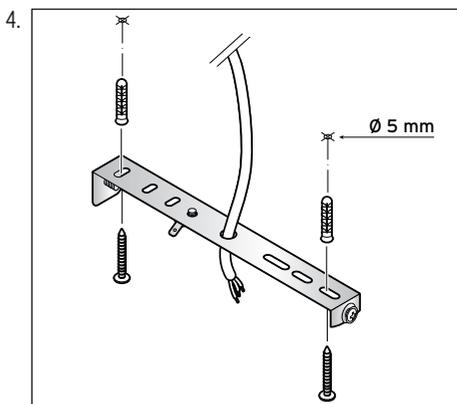
4. Percez les trous pour les chevilles et fixez l'étrier de suspension au plafond avec les chevilles et les vis fournies.
