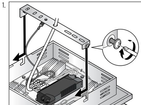
Engagez le luminaire sur les deux vis de serrage de l'étrier de fixation, légèrement vissées.
