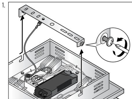
1. Dévissez les deux vis latérales fixant l'étrier de la suspension au cache-fils jusqu'à ce que vous puissiez retirer l'étrier.
