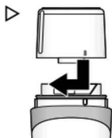
▷ Pour la fixation, placez l'embout avec le repère gauche ■ sur l'encoche du manche et tournez-le dans le sens des aiguilles d'une montre jusqu'à ce que le repère droit ■ pointe vers l'encoche du manche.
