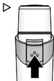
▷ Poussez l'interrupteur marche/arrêt vers le haut pour allumer l'appareil.
