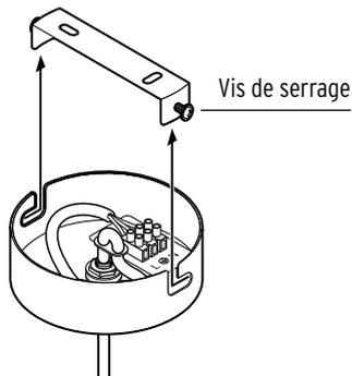
2. Dévissez les deux vis latérales fixant l'étrier du luminaire au cache-fils jusqu'à ce que vous puissiez retirer l'étrier.
