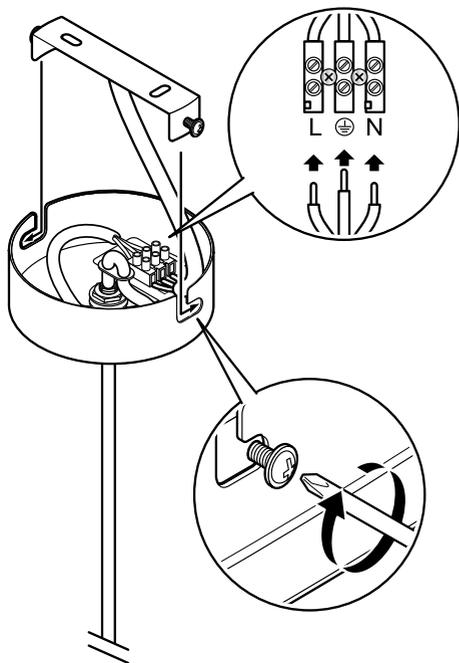
2. Engagez le cache-fils sur les deux vis de serrage de l'étrier de fixation, légèrement vissées.
