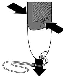
1. Appuyez des deux côtés sur les surfaces d'appui et retirez le couvercle du compartiment à piles de l'appareil.
