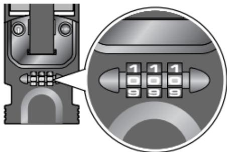
1. Tournez les molettes à chiffres de façon à ce que les trois chiffres composant la combinaison actuelle soient parfaitement alignés.
