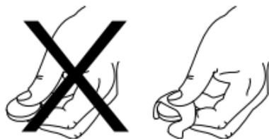
Si vous touchez la pile avec les mains nues, les dépôts laissés par vos doigts pourraient causer des faux contacts. Quand vous mettez la pile en place, tenez-la donc toujours avec un chiffon doux et sec.
