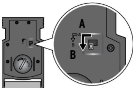
2. Retournez la boucle et poussez le petit levier métallique situé à l'arrière de la boucle dans le sens de la flèche, de la position **A** à la position **B**.
