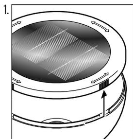
1. Pour chaque lampe, tournez le cache de la tête de lampe dans le sens inverse des aiguilles d'une montre et retirez-le vers le haut.
