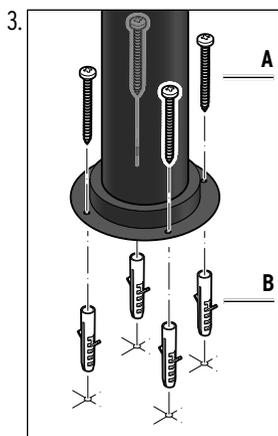
3. Percez les trous et fixez le socle au sol avec les vis **A** et les chevilles **B**.
