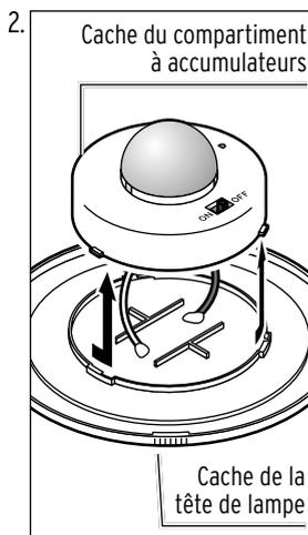
2. Pour chaque lampe, tournez le cache du compartiment à accumulateurs dans le sens inverse des aiguilles d'une montre et retirez-le vers le haut.
