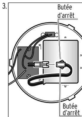
3. Pressez sur les butées d'arrêt de la fiche de l'ancienne batterie d'accumulateurs et retirez la fiche. Utilisez une pince plate si nécessaire.
