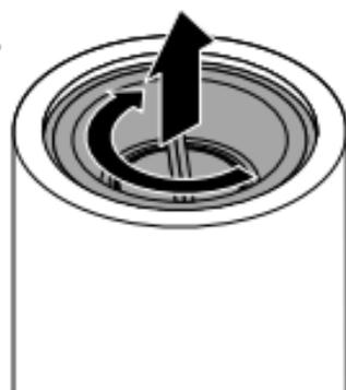
Retournez le moulin à graines de lin, tournez l'entonnoir dans le sens des aiguilles d'une montre et retirez-le.
