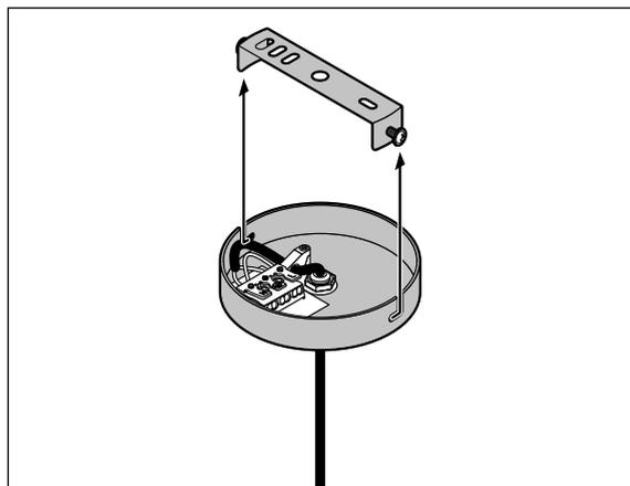
3. Desserrez les deux vis latérales fixant l'étrier de plafond au support de la suspension de manière à pouvoir retirer l'étrier.
