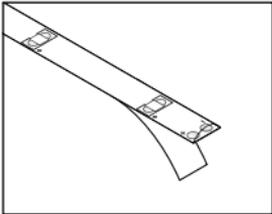
Retirez le film de protection du ruban auto-adhésif. Fixez avec soin la bande lumineuse sur le support choisi en appuyant légèrement dessus. Placez et attachez l'élément de fixation en conséquence.
