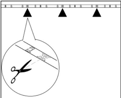
Si besoin, raccourcissez la bande lumineuse avec des ciseaux tranchants sur l'un des endroits couleur cuivre prévus à cet effet (huit au total). Découpez-la en suivant bien la ligne noire.
