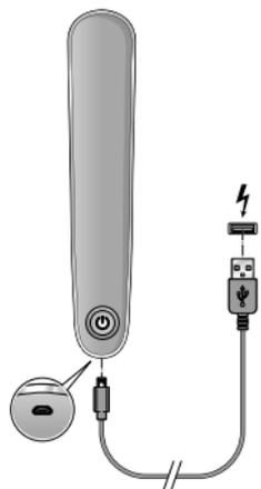
1. Branchez la fiche micro-USB du câble de charge USB dans la prise située sous l'appareil.
