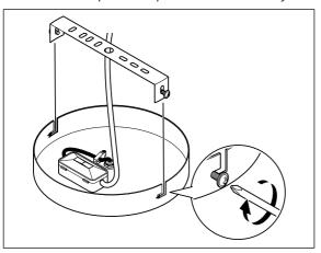
2. Faites glisser le support du luminaire vers le haut par-dessus les vis de fixation, puis resserrez les vis de fixation.
