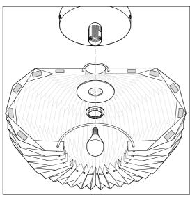
3. Enfilez l'abat-jour et la rondelle sur la douille, puis vissez l'abat-jour et la rondelle sur le support du luminaire avec la bague filetée.
