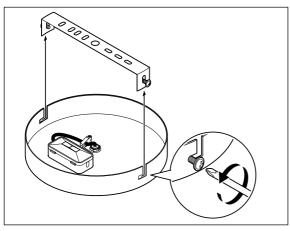
3. Dévissez les deux vis latérales fixant l'étrier de plafond au support du luminaire jusqu'à ce que vous puissiez retirer l'étrier.
