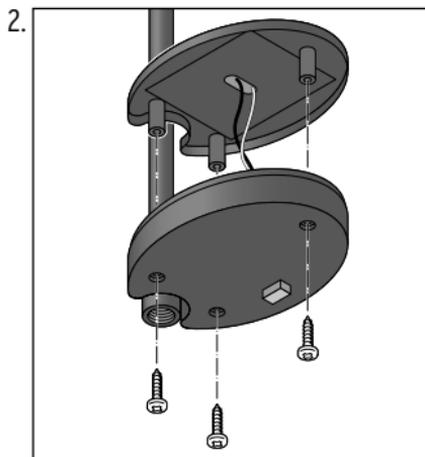
Desserrez les vis sur la face inférieure du module solaire avec un tourne-vis cruciforme et retirez le cache.
