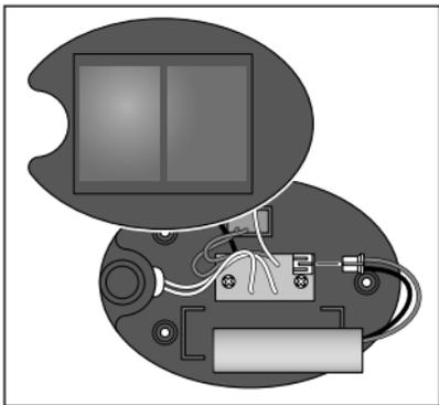
Le boîtier électronique est relié au couvercle du compartiment de la batterie par des câbles. Retirez donc le couvercle avec précaution pour ne pas arracher ces câbles.
