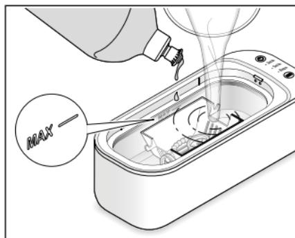
3. Remplissez l'appareil d'eau et ajoutez-y deux ou trois giclées de produit à vaisselle doux ou de solution spéciale pour nettoyage aux ultrasons.
