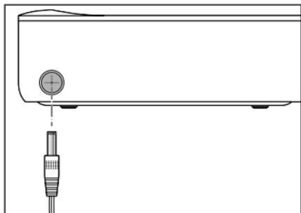
5. Branchez l'adaptateur secteur sur la prise de l'appareil, puis sur une prise de courant facilement accessible.
