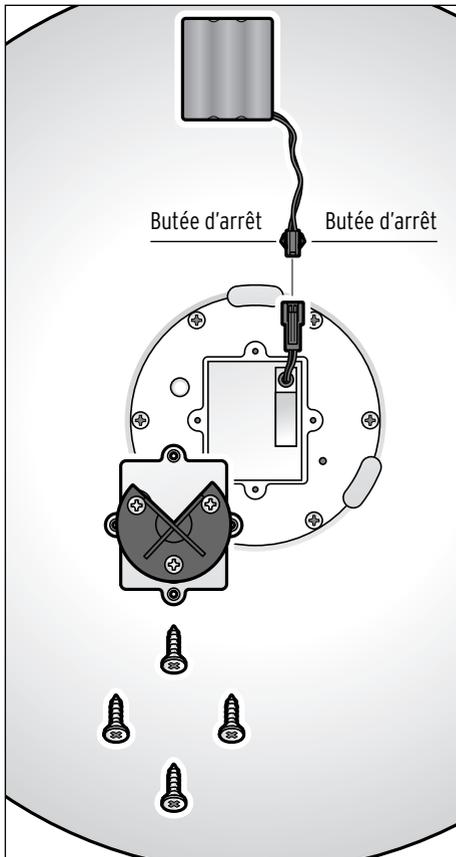
1. Desserrez les quatre vis du couvercle du compartiment à accumulateurs à l'aide d'un tournevis cruciforme.
