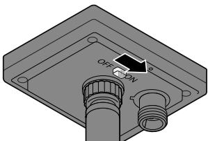
▷ Poussez l'interrupteur situé sous le module solaire sur **ON** pour activer la guirlande lumineuse.
