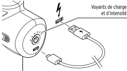
1. Branchez la fiche du câble de charge USB-C fourni dans la prise de charge de l'appareil.
