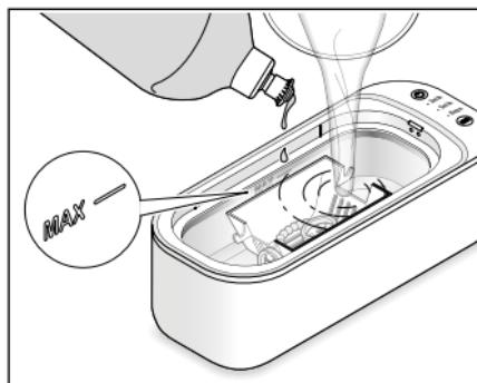
3. Füllen Sie Wasser in das Gerät und geben Sie zwei bis drei Spritzer mildes Spülmittel bzw. spezielle Ultraschallreinigungslösung hinzu.
