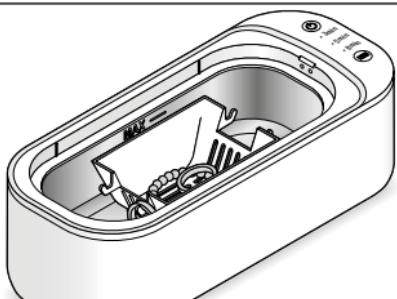
2. Setzen Sie vorsichtig den befüllten Siebeinsatz in das Gerät.
