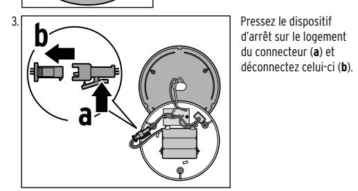
4. Retirez le bloc-batterie usagé de son support et insérez le bloc-batterie neuf à sa place.
