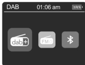
1. Appuyez brièvement plusieurs fois sur l'interrupteur marche/arrêt **⏻/MODE** pour basculer entre les modes Digital Radio (**DAB+**), Radio FM (**FM**) et *Bluetooth*®.
