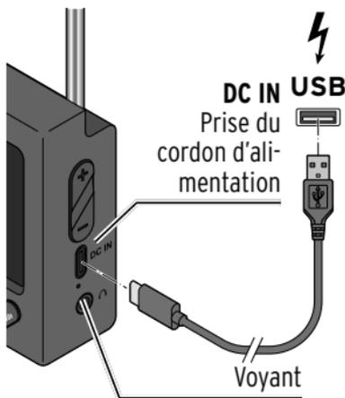
▷ Raccordez un adaptateur secteur USB à la prise **DC IN** à l'aide du cordon d'alimentation fourni et branchez l'adaptateur sur une prise de courant aisément accessible.
