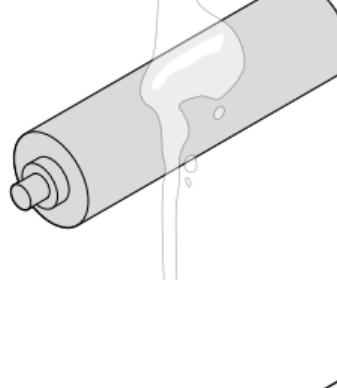
Nettoyer la cartouche anti-peluches sous l'eau chaude et laissez-la sécher soigneusement.
