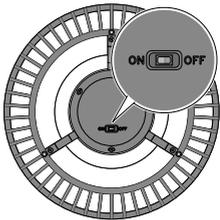
▷ Poussez l'interrupteur situé sous le luminaire sur **ON** pour activer le luminaire.
