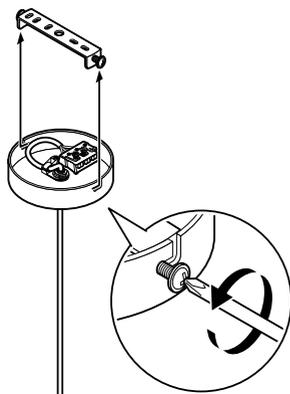
3. Dévissez les deux vis latérales fixant l'étrier de plafond au baldaquin jusqu'à ce que vous puissiez retirer l'étrier.
