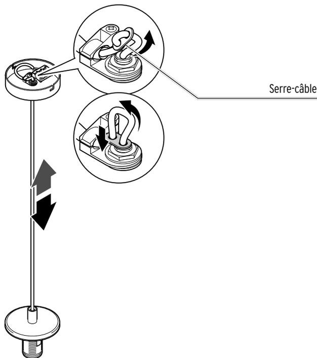
▷ Déterminez la hauteur du luminaire en faisant glisser le cordon d'alimentation vers le haut et en le fixant à la longueur souhaitée à l'aide du serre-câble.
