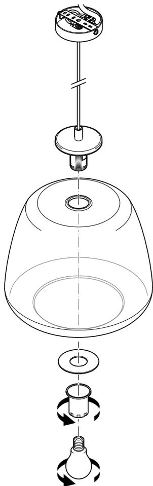
1. Dévissez le cache cylindrique et retirez le cache cylindrique ainsi que l'anneau de maintien de la douille.
