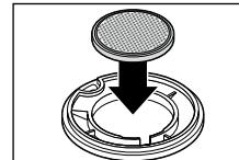
3. Retirez la pile usagée et insérez la nouvelle. Respectez la bonne polarité (+/-). Sur l'illustration, le pôle positif pointe vers le bas.
