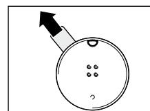
À la livraison, la pile est déjà installée. Pour l'activer, retirez la bande isolante. Celle-ci est fermement maintenue entre les moitiés du boîtier. Tirez dessus avec force et le plus droit possible pour la sortir du compartiment à piles, sans la déchirer.
