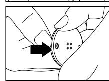
2. Retirez le couvercle du compartiment à piles en appuyant dans la fente avec l'ongle.
