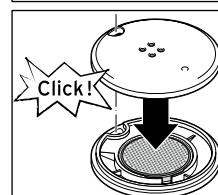
4. Replacez le couvercle du compartiment à piles et tournez-le fermement dans le sens des aiguilles d'une montre.
