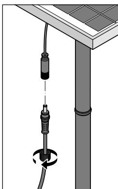
1. Débranchez la pompe du module solaire: pour ce faire, dévissez l'écrou-raccord du câble de raccordement et retirez la fiche de la prise.
