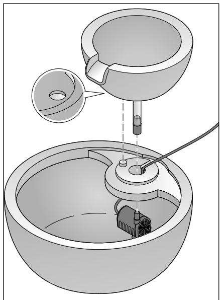
5. Placez la vasque supérieure sur la surface de pose en enfonçant le tuyau dans le trou. L'ouverture «Position» située sous la vasque supérieure doit être bien calée sur l'embout de réception «Position» situé sur la surface de pose. Faites attention à ne pas coincer le câble! Mettez le tuyau sur la pompe à l'aide de la pièce de raccord.
