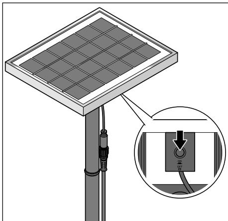
▷ Pour allumer et éteindre la fontaine, appuyez sur le bouton situé sur la face inférieure du module solaire.
