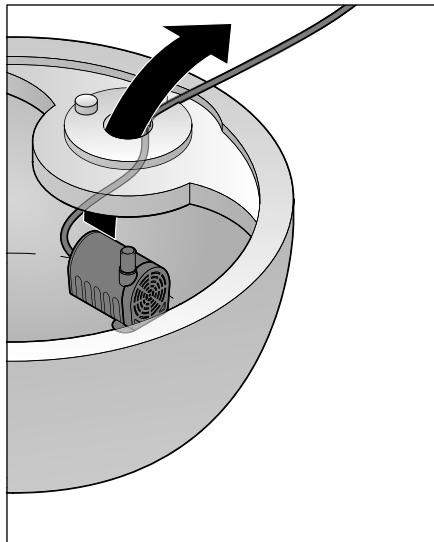
4. Mettez la pompe dans la vasque sous la surface de pose de la vasque supérieure, puis faites d'abord passer le câble par le trou de bas en haut. Placez le câble dans la rainure.
