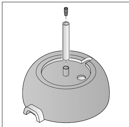
3. Enfilez le tuyau sous la vasque supérieure: enfoncez-le complètement sur le support de maintien. Retirez la pièce de raccord de la pompe et enfoncez-la dans la partie inférieure du tuyau.
