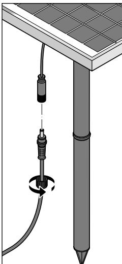
3. Branchez la fiche du câble de raccordement dans la prise et serrez bien l'écrou-raccord.
