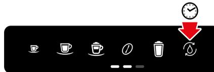
3. Dès que toutes les touches sont allumées, appuyez sur la touche **EasyClean** et maintenez-la enfoncée 5 secondes environ. 2 bips retentissent. La pompe injecte l'eau dans les tuyaux, l'eau s'écoule dans le récipient.
